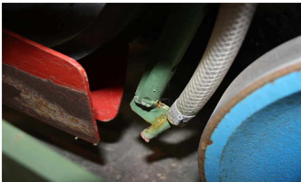
Foto 1. Udstyr til placering af flydende Ferticare i sårillen. Udstyret er her monteret på Monozentra såmaskine (med Monosem mellemtrykrulle).
