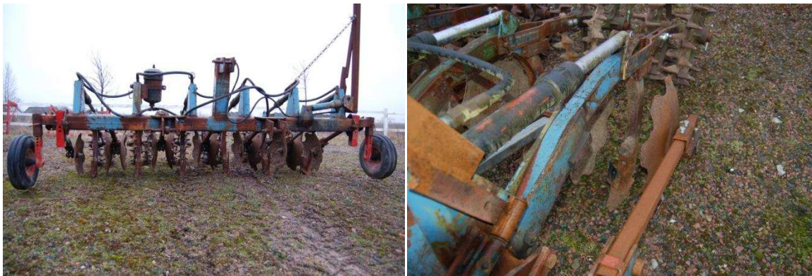
Bild 8. Maskinen som användes för partiell bearbetning. En kultivatorpinne står för bearbetningen, en tallrik på varje sida skyddar området mellan raderna och sist återpackar två vältringar.
